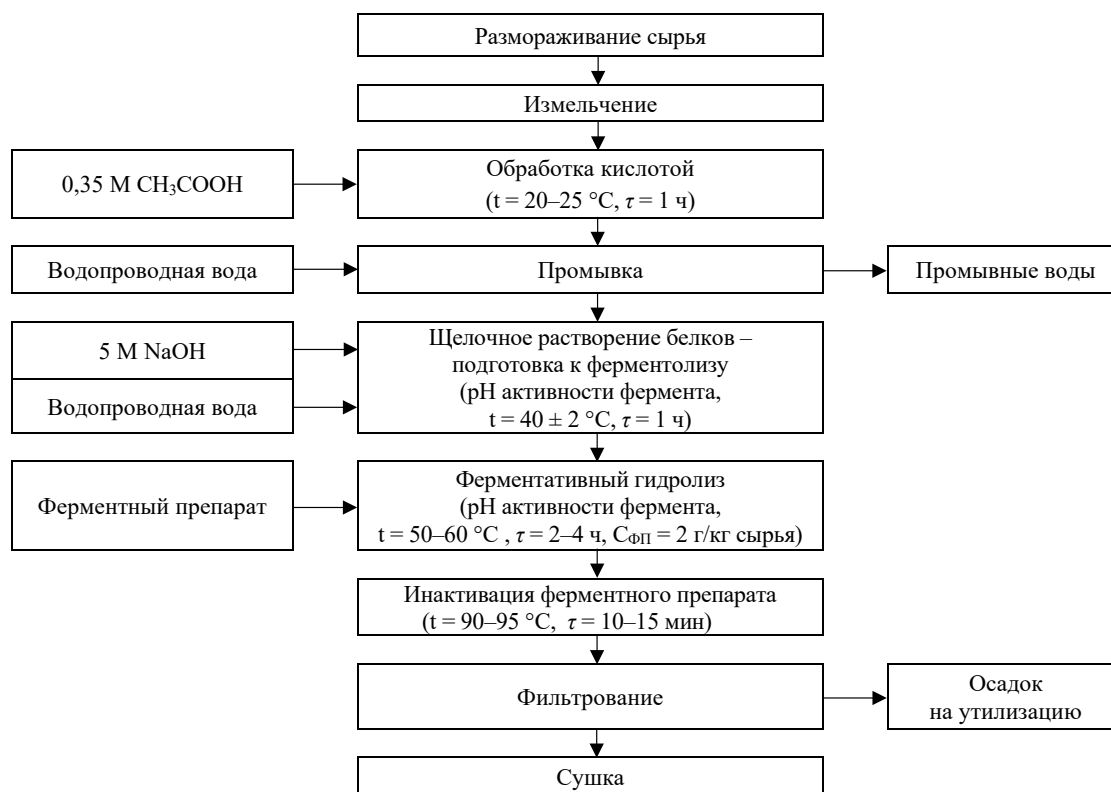
Рисунок 4. Технологическая схема получения белкового гидролизата, включающая стадию обработки сырья раствором уксусной кислоты
