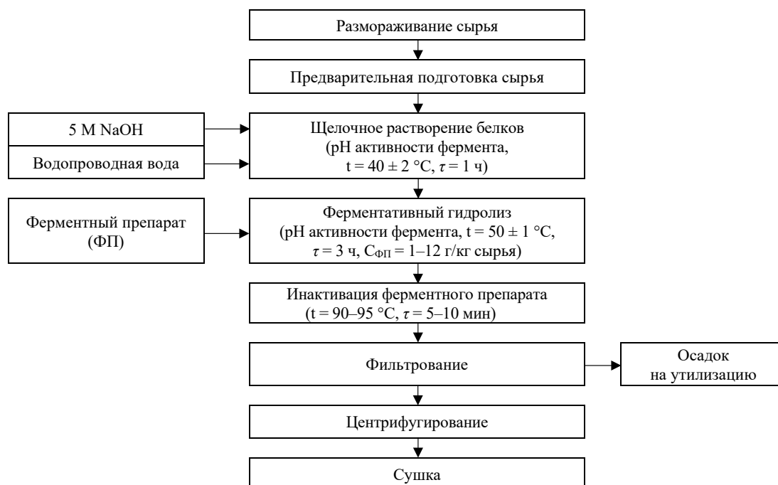
Рисунок 1. Технологическая схема получения ферментативного рыбного белкового гидролизата
